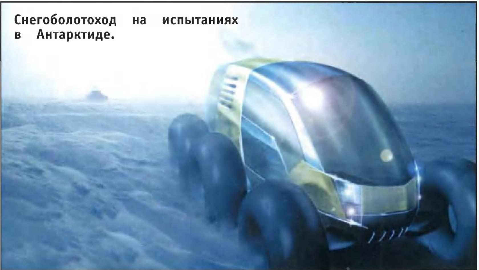
снегу и тонкому льду, по весенней и осенней распутице, а то и по болоту могут пройти вездеходы с супербольшими колесами. Нагрузка же на почву столь мала, что машина не оставляет следов в тундре, на ней безбоязненно можно выехать на засеянное поле — всходам ничего не будет. Наконец, такие вездеходы легко форсируют любую водную преграду.
