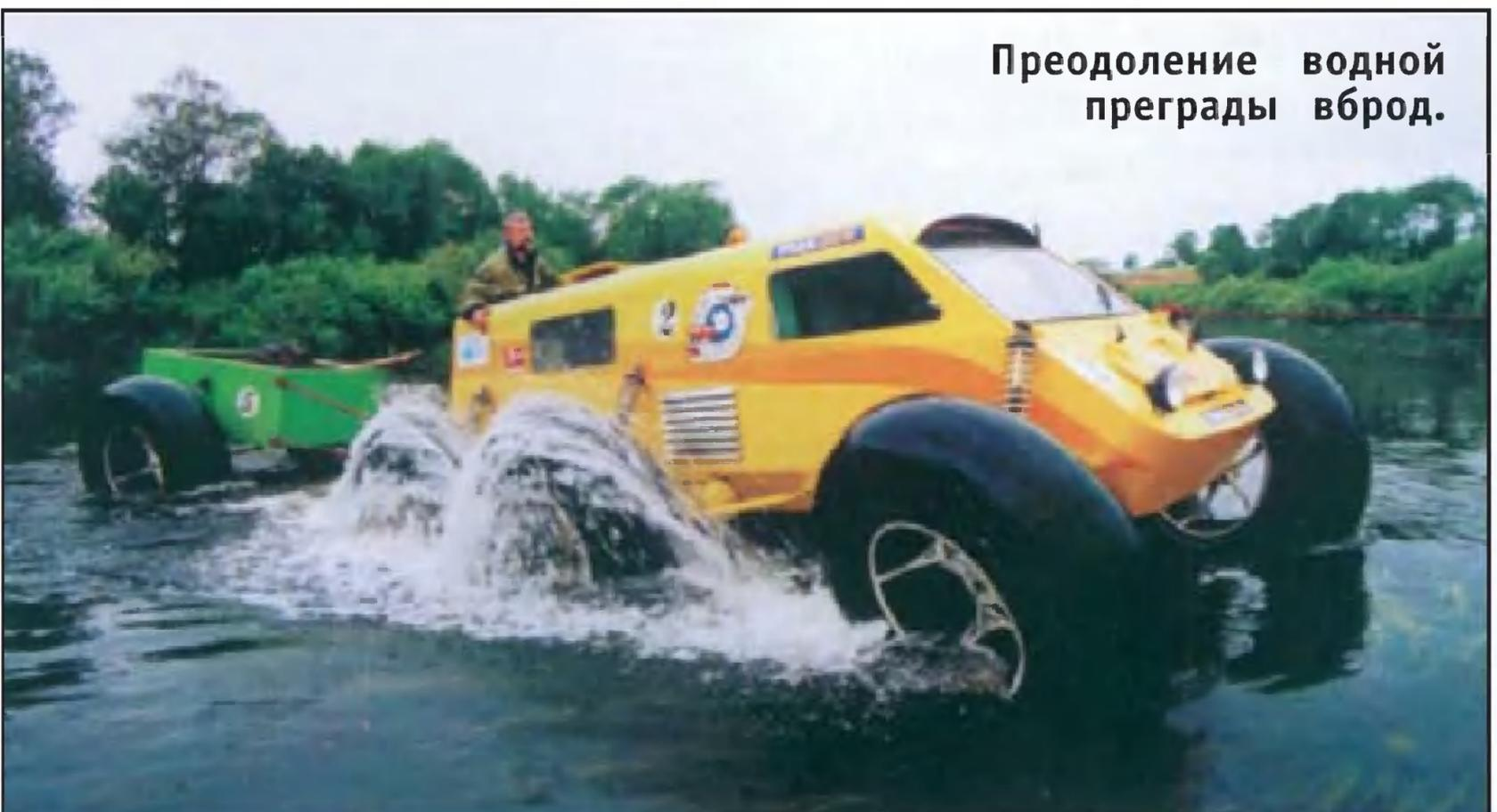
Шины в этом случае превращаются в поплавки, а машина даже при полной нагрузке скользит по поверхности воды, словно водомерка.
